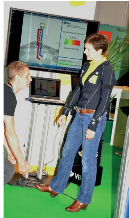
Abbildung 2: Präsentation der Belastung des Muskel-Skelett-Systems mit Hilfe des CUELA-Systems auf Showtech 2013 am Messestand der VBG (Foto: VBG)
